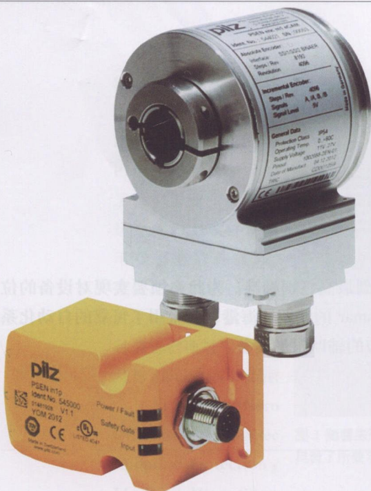
图2 用于确定位置和速度的 PSENenco 编码器（左）与“安全电子凸轮控制器”相连接替代了机械式的凸轮轴开关，安全的 PSEnini 接近式开关用于监测起重机的悬臂的旋转运动
