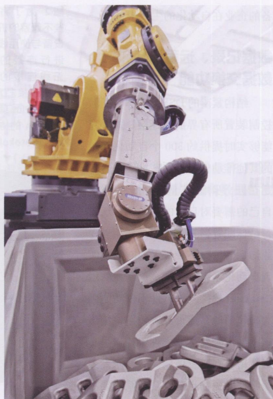
为了实现到箱子内智能化地抓取工件，机器人需要有一个 3D 目标识别装置和若干个专用抓钳
