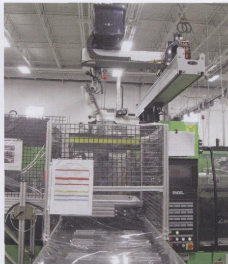
图 4 增材制造技术还支持公司自主生产设备。一些 机器人臂端夹具，例如图中正在移动中的部件，如 今已可通过 FDM 机床制造，再无需委托外部供应商 制造
