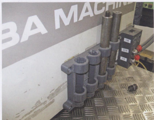
图5 脱模杆也通过 FDM 机床进行制造
