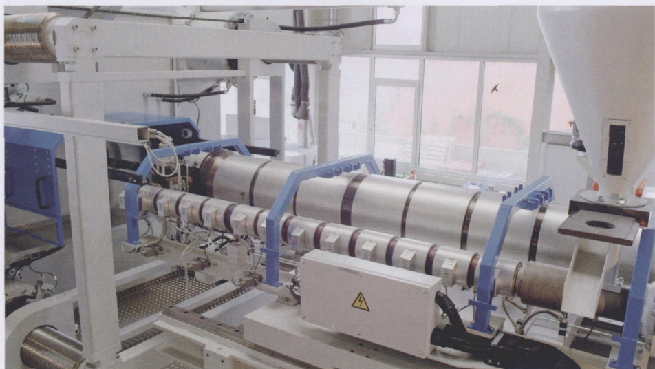
图4 该注塑设备可以在一次连续性挤出运动中生产出具有最大体积和重量等级的、需要有很长冷却时间的塑料成型件。注塑机的液压设备可以只使用一套液压系统
