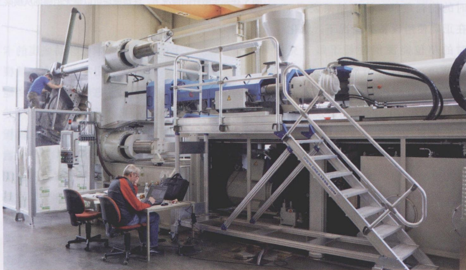
图3 大型的 Ettlinger srm 2000/130 型塑料注射设备把 4 横梁-双模板锁模系统和分级塑化-注塑系统集成到一起了
