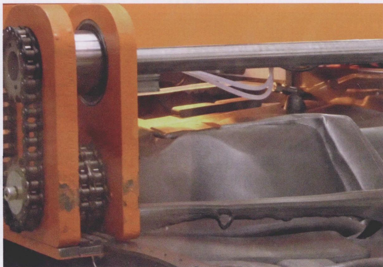
图3 卤素射灯能够快速地完成敏感的泡沫薄膜加热
