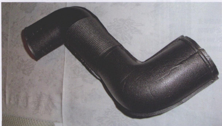
图2 利用聚乙烯泡沫制作的成型件：利用卤素射灯加热，用 Twin Sheet 技术成型制作成轻巧且功能性很好的进气管
