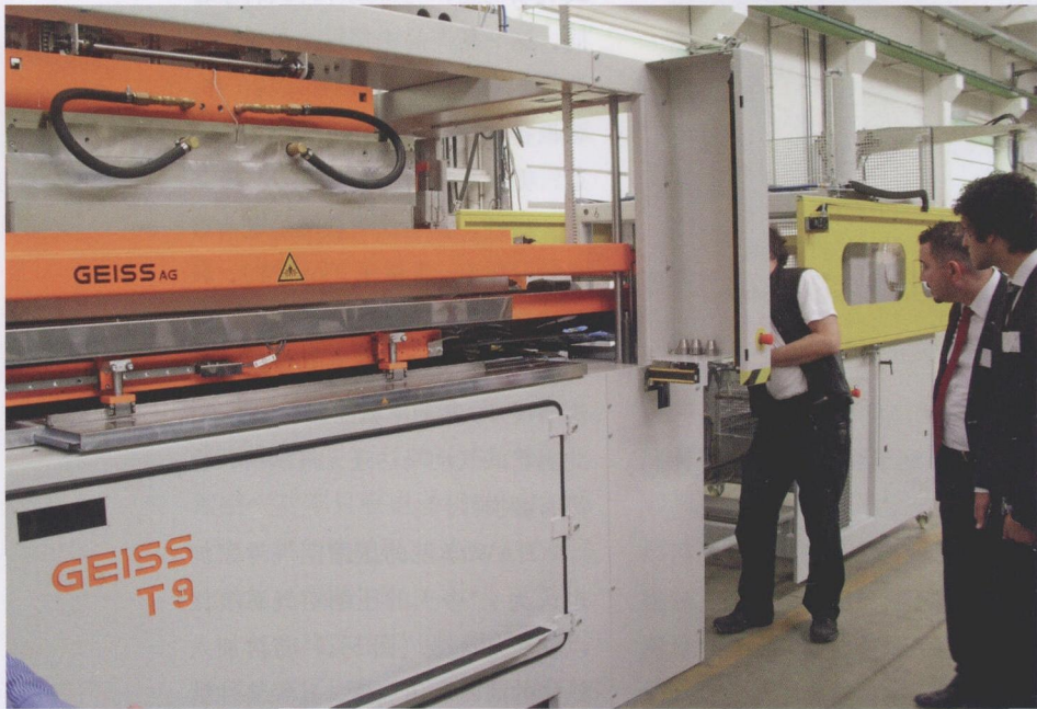
图 1 T9 型自动化热成型加工机床确保能够按照 2 ~ 3 min 的生产节拍稳定地生产泡沫材料的成型件
