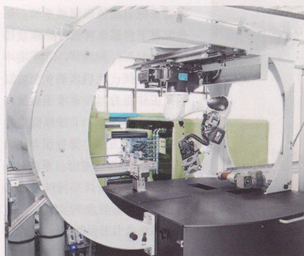
图 2 在阿博格公司的展台上, 一台库卡公司的 6 轴 Agilus 机械手被悬挂在一根横梁上。这种特殊的布置方式不仅扩大了机械手的工作范围, 而且还提升了它的取出速度
