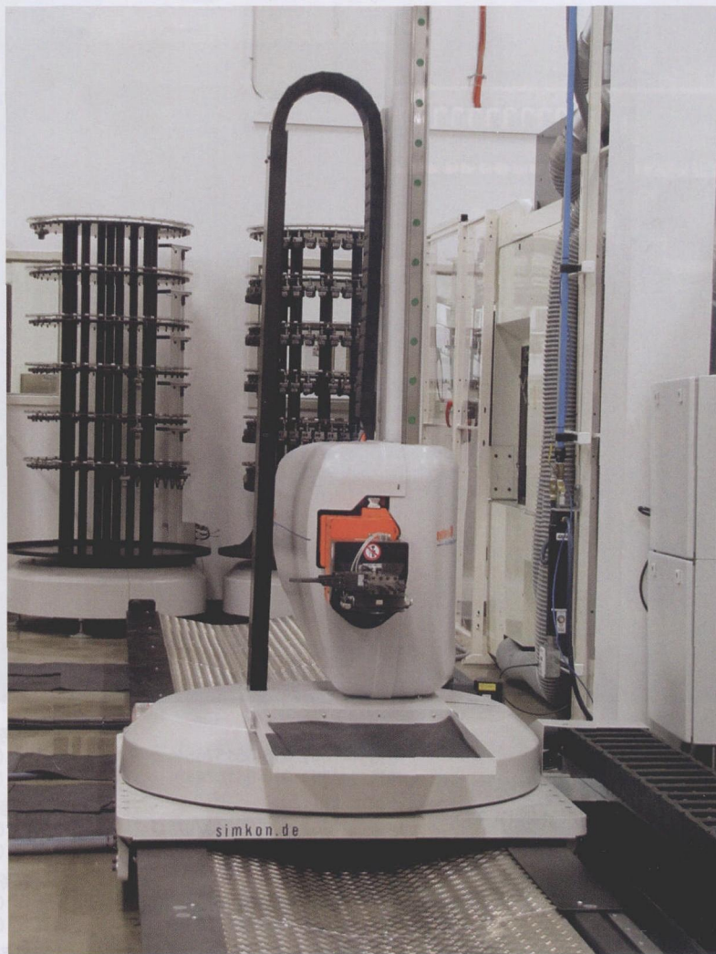
图1 一台 Workmaster 机器人正服务于加工单元中所有的机床和设备,并且它不会对操作员在离线的机器上加工自定义工件造成干扰
