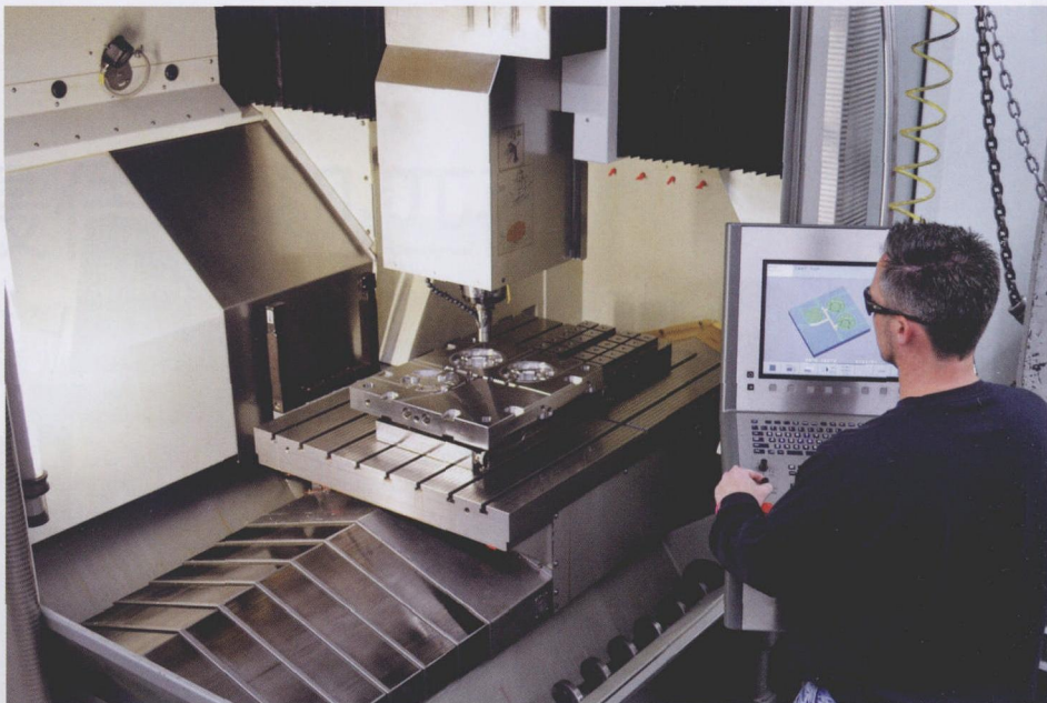
图 2 工厂经理 Joe King 在 DMC 105V 机床上进行精铣削加工操作
