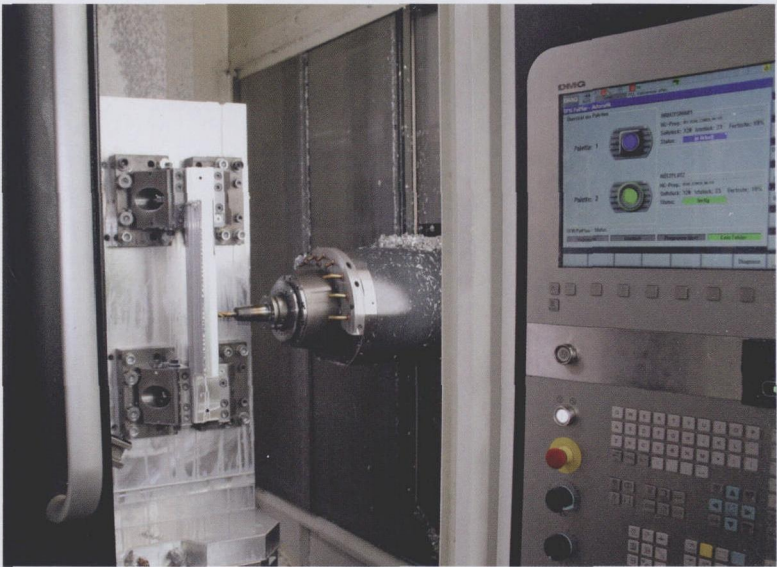
图3 使用 HPC 铣刀进行加工时，机床进给更高，切削深度更大且工件表面加工质量更好
