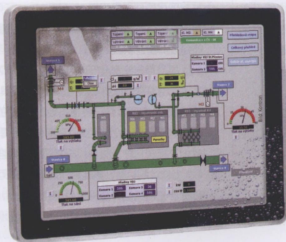
图 1 在苛刻应用环境条件下，如食品工业所使用的控制 PC，价格相对昂贵，其原因是此类 PC 必须设置得具备特别高的防护等级性能。新的低功率技术不仅为控制 PC 满足上述要求创造了理想前提条件，而且还能够满足用户取得成本效益的需求
