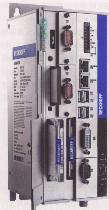
图 3 德国 Beckhoff 公司采用先进的多核技术设置工业用 PC
