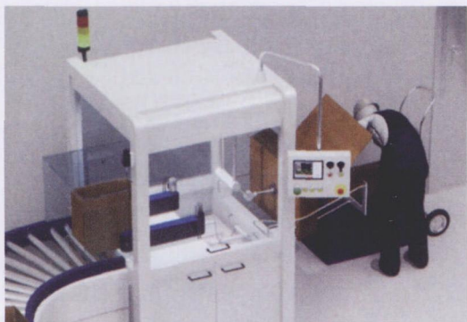
图3 如果机器设备有2个安全保险部位, Protect Select 能够为每个安全保险部位分析控制最多由3个安全保险转换装置发出的信号
