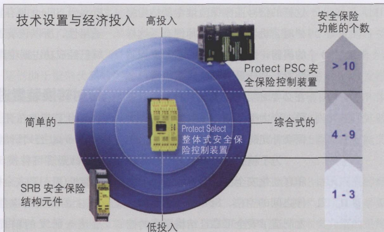
图2 新型且完整的机器设备安全保险装置, 填补了固定布线的保险继电器结构组件和整体式程序化的自动化安全控制装置间的空白
