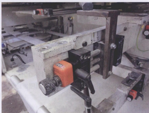
图2 带有丝杠锁紧装置、定位显示器和手轮的 SHTP-12 丝杠机构可以快速完成高精度的位置调整
