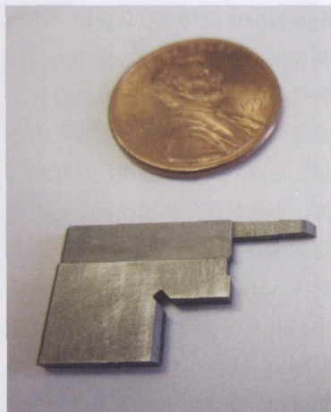
图4 这种模具镶件是 Wire Specialists 公司典型的加工部件。在这个部件角部可以观察到小槽口的直径测量值为 0.003 in，而且要求加工成圆角
