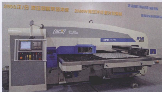
图 2 在北京 CIMT 机床展中济南铸造厂展示的 HPD 31225 型板材加工设备就是全球首台采用 HDM 液压驱动系统的中等厚度板材加工设备
