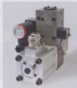
图 4 DECV 直驱式仿形电磁阀的工作原理与常规伺服阀截然不同，且没有敏感的先导控制油路，而是由伺服电动机直接驱动
