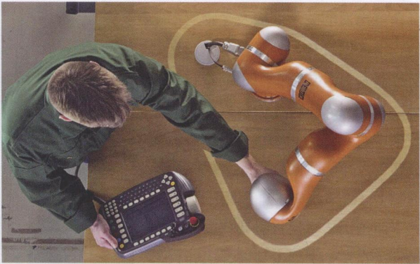
图4 采用以投影仪相机技术为基础的传感器系统进行工作区域的监控
