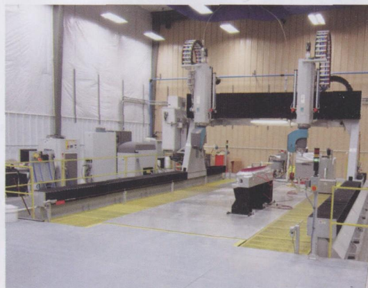
图 3 Royal 公司的 CMC 是第一台安装在美国的由 Flow 公司出品的 Size B 型。其模块化设计允许添加额外的 X 轴导轨，延长机床的纵向行程
