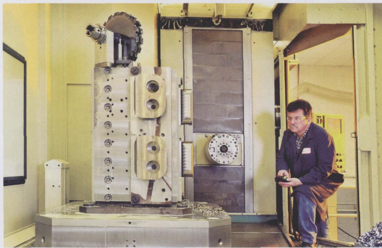
图 2 车间工长 Walter Dzikowski 在检查工件的墓碑式夹具，其特点是有厂里专为 50 lb 自定义铣刀而设计和制造的刀库
