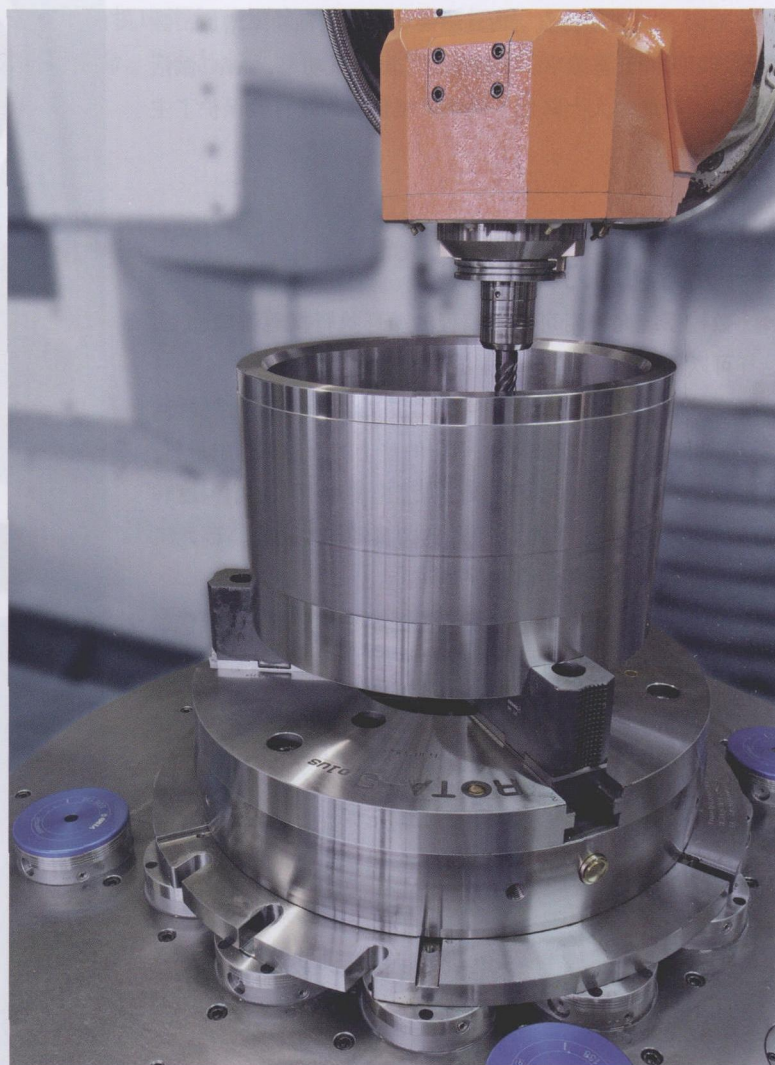
图 1 在夹持圆形工件方面，可以配备带有零位装卡系统相应接口的旋转卡盘
