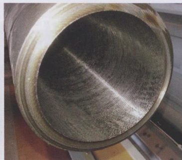
图3 离心浇注原油的管件加工前和加工后的效果：加工前的离心浇注原油的管件孔壁表面（a）和加工后的离心浇注原油的管件孔壁表面（b），加工前的离心浇注原油的管件孔壁表面已生成了很厚的氧化皮
