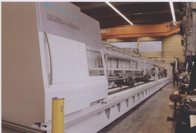
图 2 在 ML 500 系列深孔钻床上加工离心浇注原油的管件
