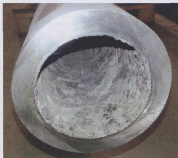
图3 离心浇注原油的管件加工前和加工后的效果：加工前的离心浇注原油的管件孔壁表面（a）和加工后的离心浇注原油的管件孔壁表面（b），加工前的离心浇注原油的管件孔壁表面已生成了很厚的氧化皮
