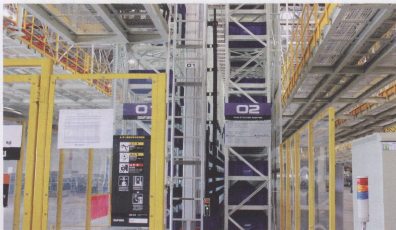
图 1 自动化高架库用于 KSK 线束的仓储、排序和上线
