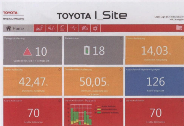
图2 Toyota I Site 控制面板上生成了所使用的叉车的总体生产数据，形成这些数据不受其位置、车队车辆数量和叉车品牌类型的影响
