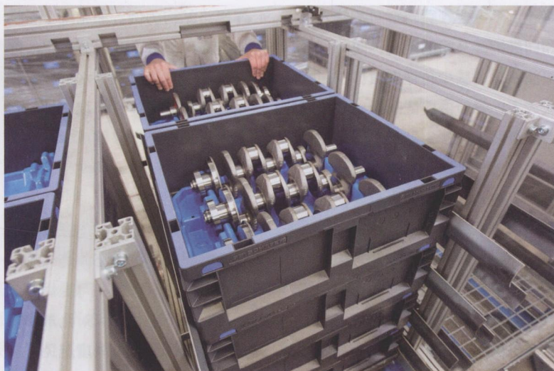
QX 系列容器的纵向一侧采用三角横梁和加固装置，以防止 QX 系列容器纵壁落下
