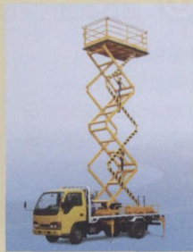
车载式高空作业台
