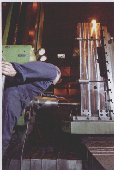
图3 Build-A-Mold 公司把 Square 6 刀片的切削角设置为 90^\circ ，可直接加工 90^\circ 的侧壁，且无需二次插铣操作
