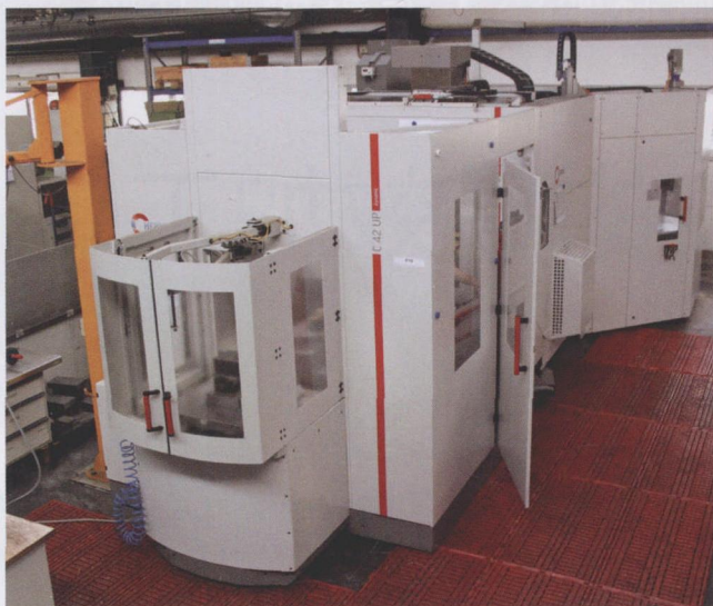
图1 加工中心的托盘式换刀装置设置在机床正面的机头座内
