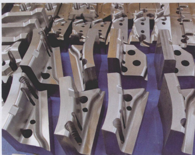
图2 由 Berthold Hermele 公司提供的自动化生产加工系统主要是用于加工 1.2379 型工具钢材质的冲头、刀具和夹具
