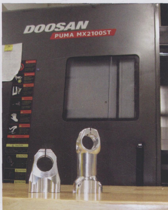
图1 右侧是 Amp 立管的主要机加工部件，左侧是采用了较早立管设计方案的相同部件，这个较短的立管可以完全在同一台加工中心上完成，而 Amp 立管的圆柱型管身部分属于车削部件
