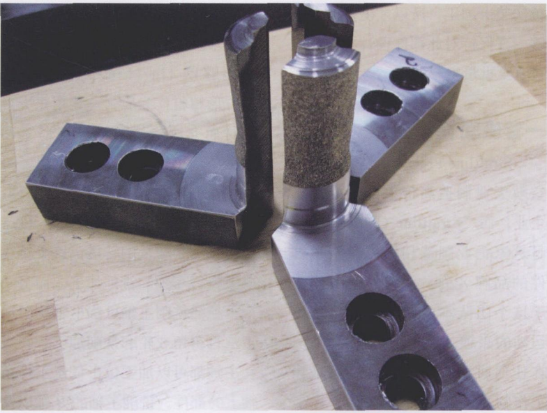
图 3 内径夹具上的钨合金涂层解决了第 2 主轴加工时部件易打滑的问题，这一技术也是最终实现无人执守加工所必需的要素之一
