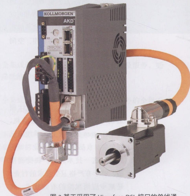
图3 基于采用了 Hiperface DSL 接口的单线通讯使得电动机与电动机变频器之间的连接只需一根电缆就可以了。这大大节约了电缆连接的费用；因为它省略了一根电缆、两个插头插座和相应的布线工作量
