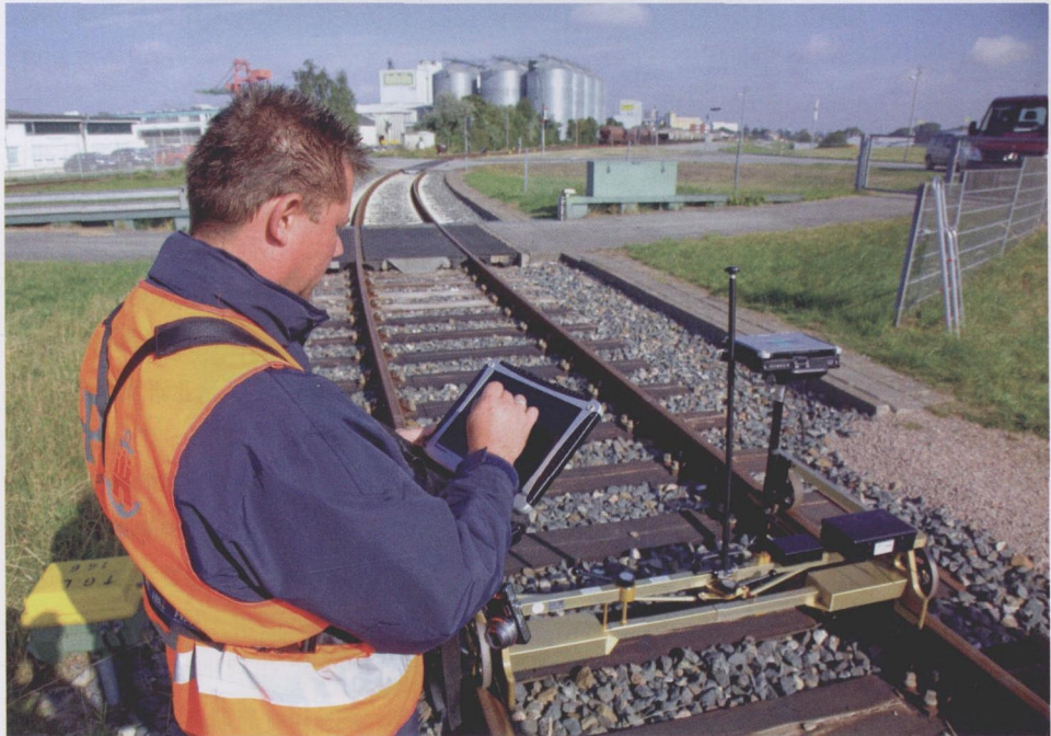
图 1 检修人员在室外利用移动式终端快速、准确地检测和记录下铁路路基的状态信息
