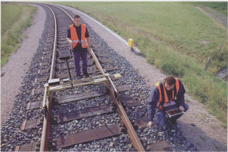
图 2 移动解决方案把地理数据传输到控制中心，并保存在系统中，以便能够在紧急情况下快速地确定故障点
