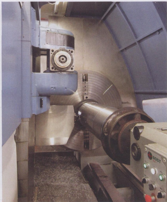
图3 博斯特 T4F 车/铣床配备了粗车作业用的“断头台”刀片、B 轴车削/铣削头以及一个摄像头，便于操作员查看从封闭控制平台很难看到的区域
