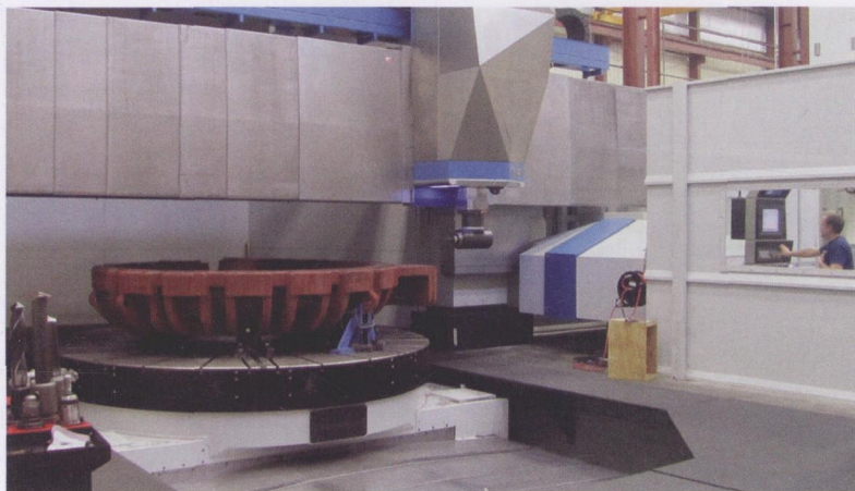
图2 博斯特 60 CY 4000 立式车削中心设有可更换的动力头,使其能够执行车削、顶部铣削和侧面铣削加工
