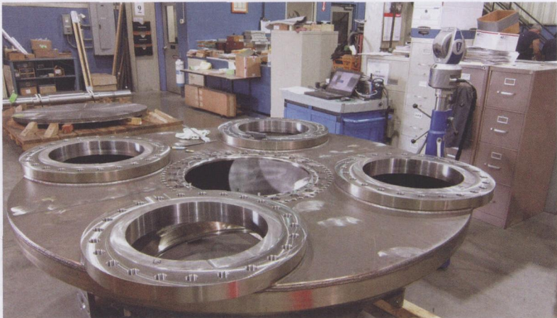
图4 Faro Vantage 激光跟踪仪用于测量大型零件。该设备将光束发射固定在工件的反光靶上，光束反射离开目标，沿原路返回跟踪器。当它重新进入时，二角编码器测量仰角和旋转角，而绝对测距仪确定反光镜的三维位置
