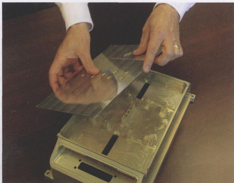
图3 一个电子件外壳的 DFM 项目,导致 Domaille 公司开发出一种“无螺栓”式的安装方法,可以使外壳盖牢固地安装就位,无需使用任何紧固件
