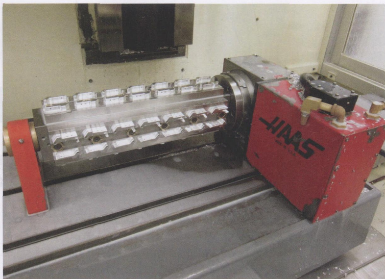
图2 Domaille 公司将方形加工坯料安装到 Hass 分度器的四个面上。当所有零件外形加工完成以后,通过分离操作,将每个零件从备料中分离出来
