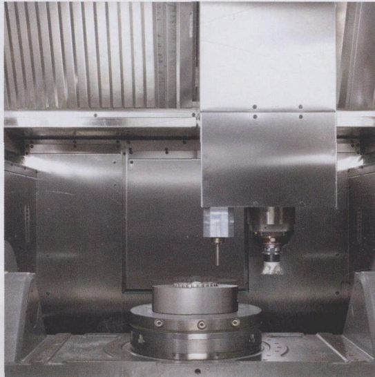
图 4 在模具插件的生产过程中，一台加工中心的工作环境及其配套的 MPA 技术
