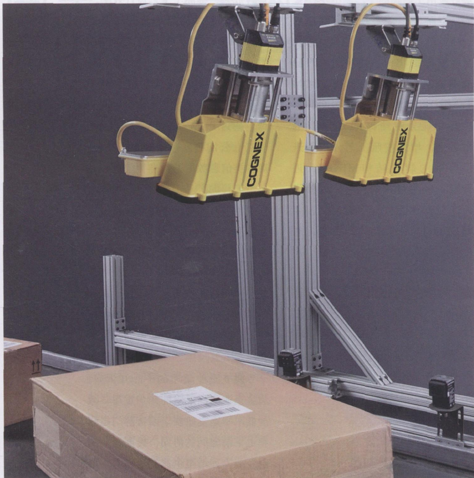
图 1 Dataman 产品系列的条码识读器可进行 ID 和 2D 码识读，能确保在所有工业领域使用，条码识读率几乎为 100%
