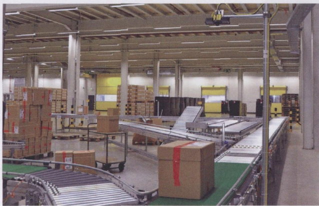
图2 Cognex 公司研制的固定 Dataman 500 型 ID 条码识读器具有高灵活性，可高速地识别不同高度的包裹条码
