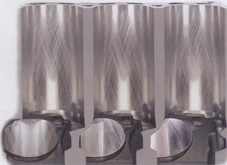
图 1 采用螺旋 滑珩磨之后的 圆柱孔
