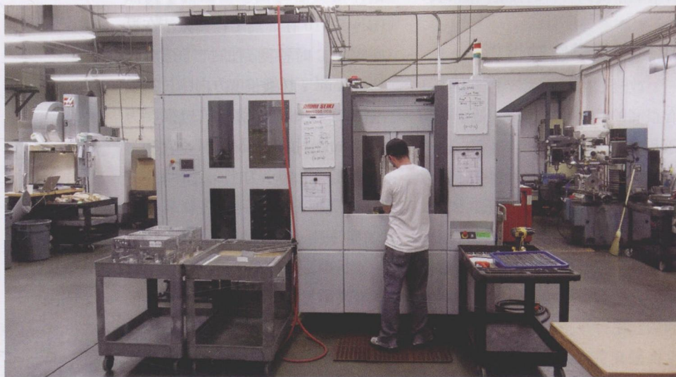
图1 卧式加工中心不仅允许在一次循环内加工大量零件，而且还可以在机加工循环仍在运行时执行装卡，这两项优点大幅减少了时间影响和单位装卡成本
