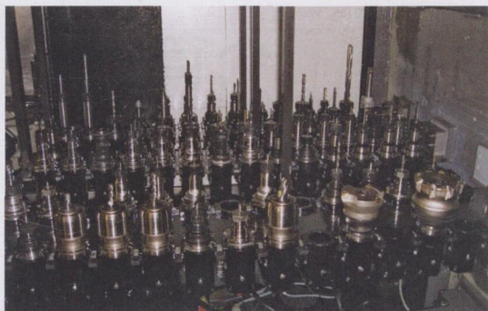
图2 刀具容量有可能是 HMC 最为重要的优点。对于 VMC 来说,不同的作业必须换装不同的刀具,但对 HMC 来说,每一把需要用到的刀具都可以保持在原位不动
