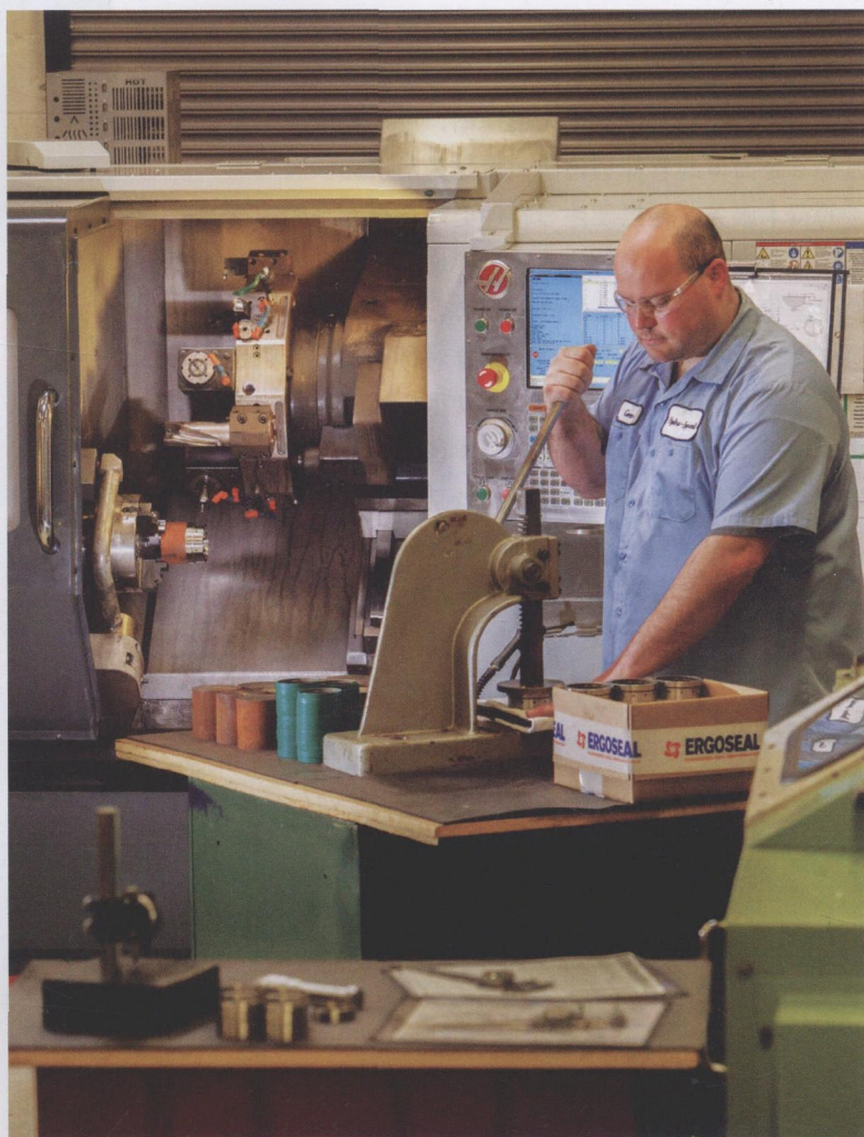
该组零件的许多部件都是在同一台机床上加工的。设备在做切削加工的同时，操作员可以组装密封件
