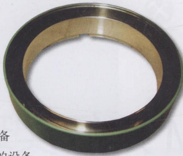
图 4 杯件要先车削，再在内部点焊凸缘，然后再次车削，以完成外径。单元格可以让这一切工作在没有在制品库存的情况下完成
