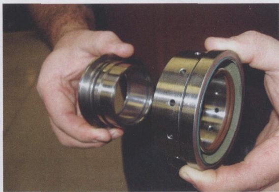
图1 这两个部件在带有的车床上加工，每件只需设置一次。前面那一件过去在加工中心上加工也需要一次设置
