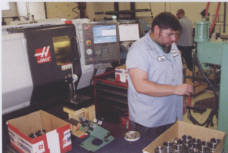
图 3 Ergoseal 公司的 Patrick Grano 在此单元格里用机加工和焊接生产各种尺寸的杯件
