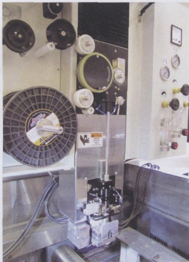
图1 最新一代电火花线切割机的先进功能促进了无人值守作业。在徕通 SP-500I 机器的内部，我们可以看到许多由它的设计者开发的这些功能，包括能使自动穿丝装置高度可靠且所带运动部件最少的机制
