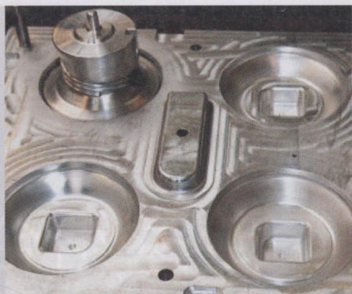
图 1 轮廓形状复杂的铸模用配有 TNC 620 数控系统的机床轻松加工
