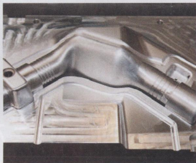
图 1 轮廓形状复杂的铸模用配有 TNC 620 数控系统的机床轻松加工
