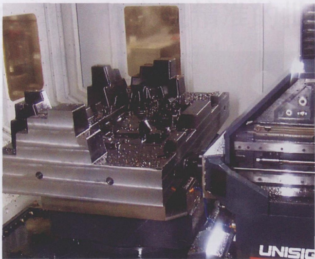
图2在 Concours Mold 公司, 深孔钻削在模具上进行。
