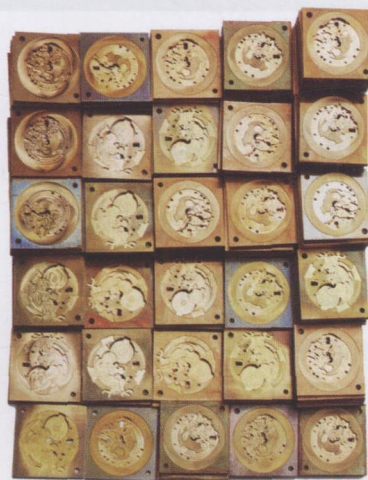
图 1 一侧加工后的底板
