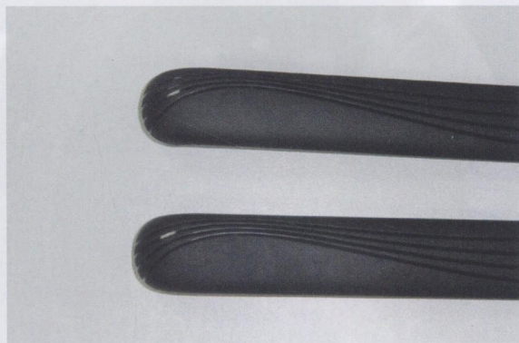
图3 使用涂层后：客户对涂层能提高模具寿命3倍以上及改善了脱模的效果十分满意
