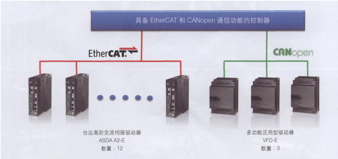
图 1 台达多轴运动控制系统架构和配线简单，扩充灵活度高
