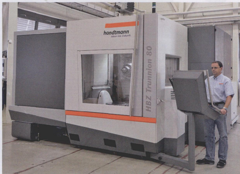
图 2 采用刚性机床设计方案，可安装一个对加工铝制件、钢制件和钛制件最为理想的心轴，或是将机床设置成理想的铝制件加工机床
