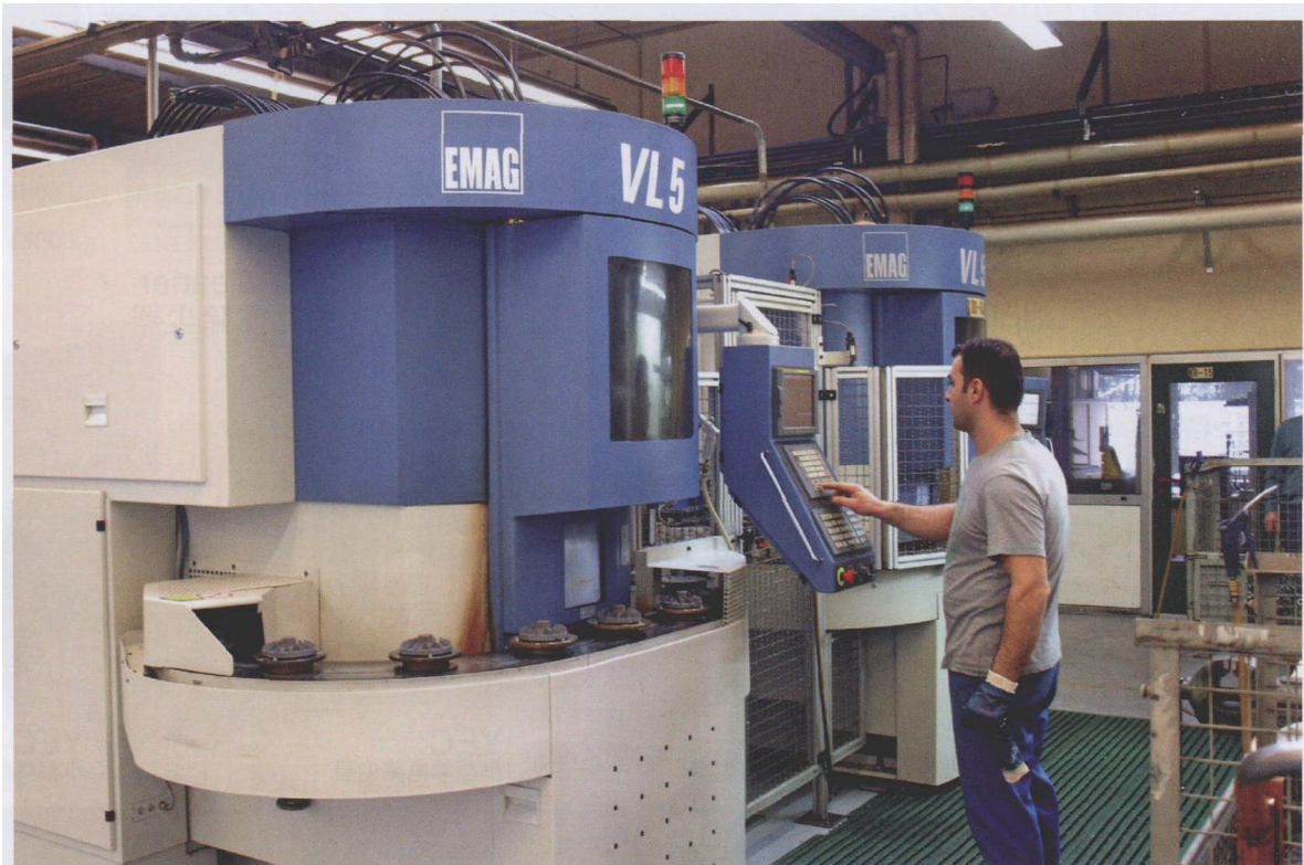
图 1 两台拥有 拣选主轴的车 床相互平行布 置，并相互联 结，以这种方 式可对很多工 件进行综合加 工
