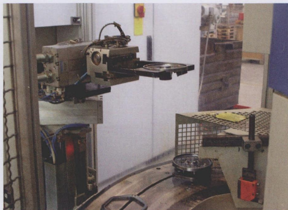
图3 两台车床由一转换单元进行相互联结，在一台车床上进行加工后，可送到另一台车床进一步加工
