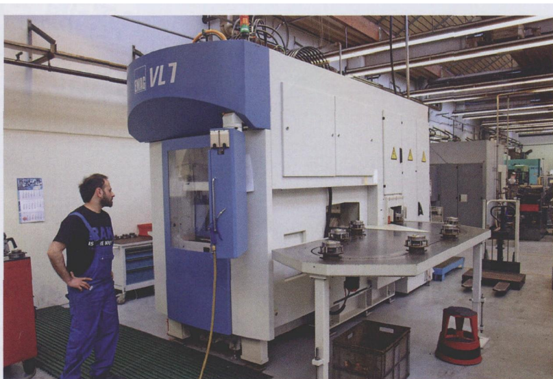
图5 Laso 公司在占地面积为 20 m 2 的加工单元里,安装 VL 7 车床,以生产较大的载货汽车结构件
