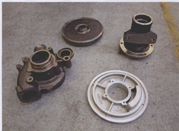
图2 该车床可加工的工件种类很多，如水泵外壳或叶轮
