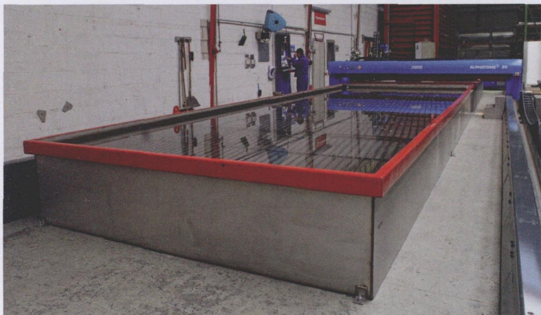
图2 高精度 Alphasome II 等离子切割装置有两个水槽（工作面积分别为 6 m×3 m 和 8 m×3 m），在一个水槽里进行切割作业，在另一个水槽里了装卸工件
