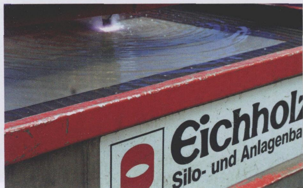
图3 高精度 Alphasome II 等离子切割机的水槽装置均由 Eichholz 公司自行设计和制造，从水槽里导出压缩空气或清水水槽只需 30 s
