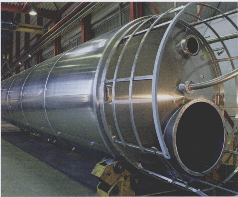
图 4 Eichholz 公司借助于水下等离子切割加工方法所生产的筒仓最大高度为 36 m，直径为 6 m
