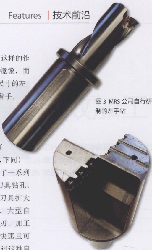
图 4 MRS 自行设计的另一种刀具，一次进给便能加工出一个直径为 4 in 的盲孔
