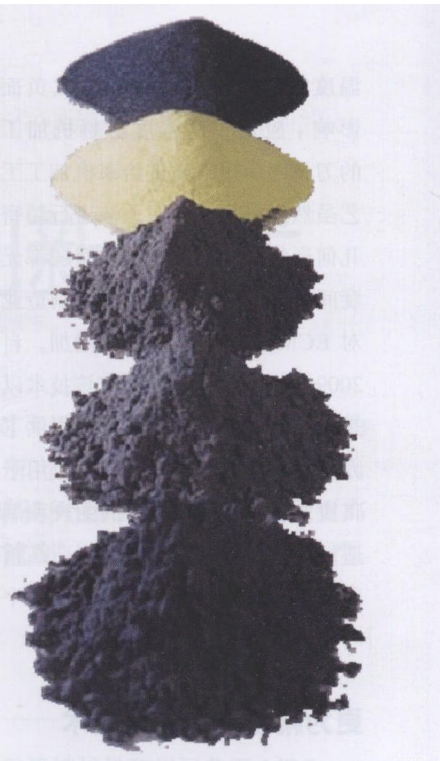
图 2 1 \mu\text{m} 的颗粒比例 98% 以上的乌合金粉末
