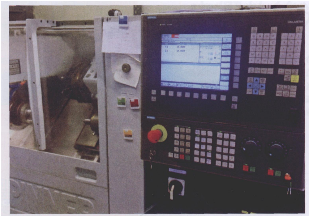
图 1 成功的技术改造：Spinner SB 型数控车技术改造后配用的是 Sinumerik 840D 控制系统，重新达到了当代最先进的技术水平
