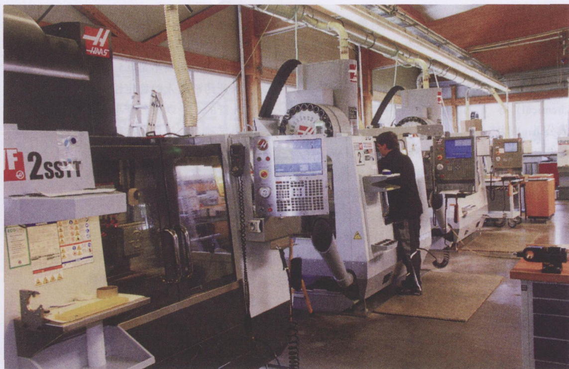
图1 Hauser 公司从建厂起到现在共有4台由 Haas 公司生产的加工中心在制造加工外科医疗器械
