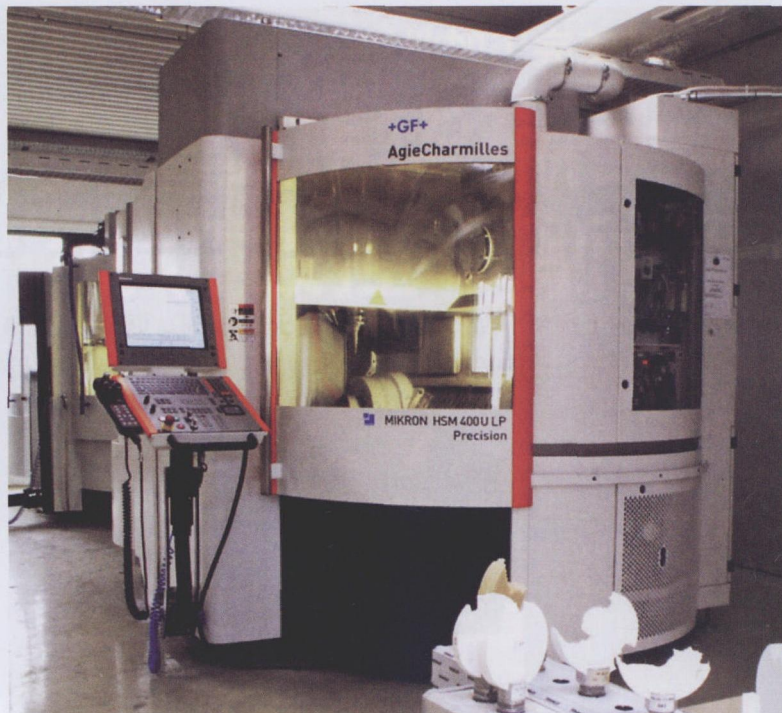
图3 Mikron HSM 400U LP 高速 CNC 数控加工中心每天可以加工 100 颗义齿。与传统的牙科技术手工制作相比较每天最多可以制作 6 ~ 8 颗
